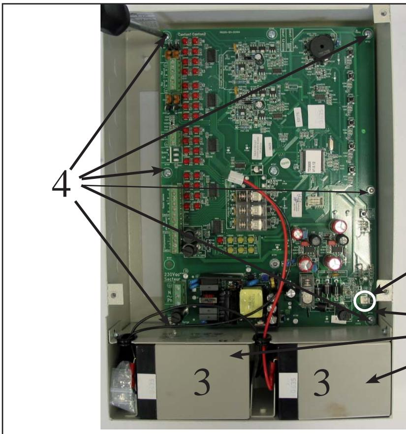
2 débrancher le connecteur batteries
