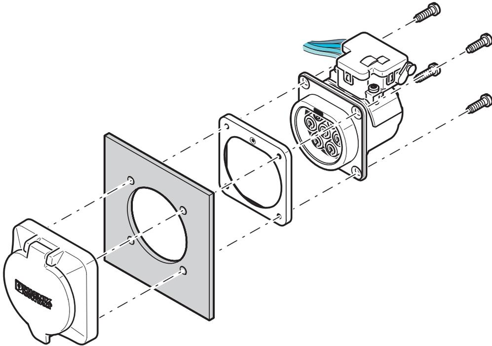
Montage sur face arrière, avec vissage du couvercle de protection à l'arrière
