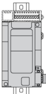
NOTE : Les modules d'extension doivent être montés au-dessus du contrôleur.
