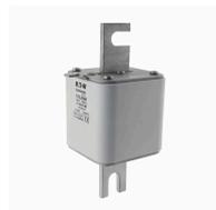
Cartouche fusible, grande vitesse, 800 A, AC 1000 V, size 3, 76 x 92 x 171 mm, aR, IEC, indicateur de fusion simple
