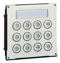
Module réalisé avec une double plaque en acier inox 316 de 2,5 mm. Équipé d'un clavier rétroéclairé. Il dispose de 300 codes différents à 8 chiffres programmables par clavier pour commander deux relais (10A), ronfleur de confirmation opération et led d'actionnement relais. Temps de fermeture du relais programmable à partir du clavier. Dimensions : 106x106x56 mm.
