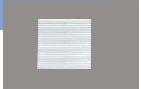
Les grilles de la série GRA-FP et GRA-FP-F ont été conçues pour les installations en faux-plafond. Elles permettent la reprise d'air froid ou chaud. La conception de ses ailettes fixes à 45° garantit une reprise d'air uniforme dans toute la section de passage et permet de cacher l'intérieur de la grille. Les versions GRA-FP-F (avec filtre) sont munies d'un système PUSH facilitant l'accès au filtre.
