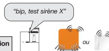
**ATTENTION : si les sirènes, les relais radio ou les récepteurs présentent un défaut d'alimentation (bloc alimentation usagé), la signalisation des sirènes, des relais radio ou des récepteurs est suivie d'un acquit sonore particulier indiquant ce défaut.**
