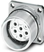
M23, Embases paroi avant, série: CA, droit, blindé: oui, Pour verrouillage standard et SPEEDCON, Nombre de pôles: 7, Sens de rotation: standard, type de contact: Connecteur femelle, Raccordement soudé, Joint plat, 4x Ø 3,2, cote de bride: 25 mm x 25 mm, détrompage: N, Produit de remplacement selon RoHS II sans exception 6c (Pb < 0,1 %) référence : 1243930
