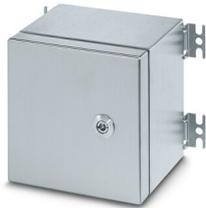
Boîtier vide, matériau: Acier inoxydable 316L / 1.4404, résistance superficielle: brossée, argenté, 300 mm x 300 mm x 160 mm, type de verrouillage: Porte avec charnière amovible, fournitures - ATD: Charnière de porte avec bouchon quart de tour, Plaque de montage, Clé à double panneton, Équerre de fixation avec vis de montage, Boulon de mise à la terre M12 positionné sur la face extérieure, Instructions d'installation, Charnière de porte avec bouchon quart de tour
