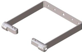
Support en acier galvanisé et peint. Vis en acier inoxydable et article de fixation en aluminium EN AB44300 faible teneur en cuivre ( $Cu \leq 0,08\%$ ). Goniomètre intégré pour un réglage rapide.
