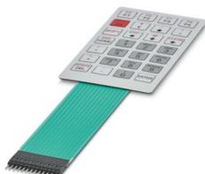
Clavier à membrane adhésif, technologie des pistes conductrices en argent, 28 touches, estampé, 4 couleurs, câble de raccordement : 124 mm, avec connecteur femelle à sertir, pas 2,54 mm, température de fonctionnement : -20 °C ... 70 °C
