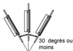
Lorsque le produit est installé dans une position ayant une inclinaison dépassant 30°, la température ambiante ne doit pas dépasser 40 °C (104 °F). Vous pouvez utiliser un dispositif de refroidissement de l'air (ventilateur, climatiseur) pour vous assurer que la température de fonctionnement ne dépasse pas 40 °C (104 °F).
