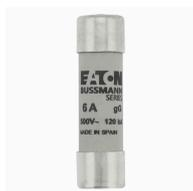
**Cartouche fusible, Basse tension, 6 A, AC 500 V, 120 kA, 14 x 51 mm, gL/gG, IEC, avec percuteur**
