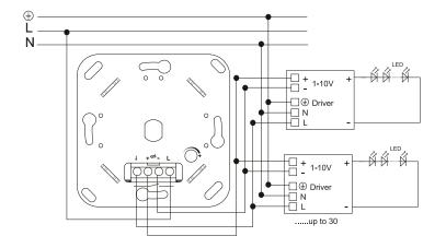
En commande de puissance directe, ne pas dépasser les 800W. Pour des puissances supérieures, il est impératif d'utiliser un relais électromécanique pour piloter l'allumage et l'extinction des produits. Le nombre de produits déprendra donc du pouvoir de coupure du contacteur.
