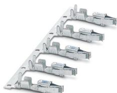
Contact femelle modulaire, à enfile dans le capot PCC ou HCC du connecteur après sertissage du conducteur, pour conducteur entre 1,5 et 2,5 mm<sup>2</sup>, sous forme de ruban
