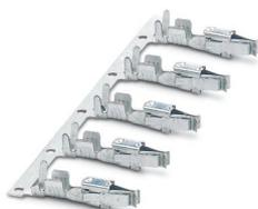
Contact femelle modulaire, à enfiler dans le capot PCC ou HCC du connecteur après sertissage du conducteur, pour conducteur entre 0,5 et 1,0 mm<sup>2</sup>, sous forme de ruban
