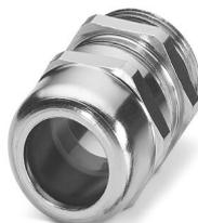
Presse-étoupe, matériau du raccordement vissé: Laiton, nickelé, diamètre extérieur du câble 15 mm ... 21 mm, blindage: non, filetage de raccordement: M32 x 1,5, coloris: argenté, avec joint torique
