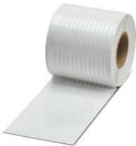
Bandes de repérage, Rouleau, blanc, vierge, repérable avec : THERMOMARK E.300 (D)/600 (D), THERMOMARK ROLL 2.0, THERMOMARK ROLL, THERMOMARK ROLL X1, THERMOMARK ROLLMASTER 300/600, THERMOMARK X1.2, type de montage: collage, surface utile: sans fin x 3,8 mm, Nombre d'étiquettes: 12
