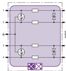
Schéma de principe du circuit BXT ML4 BD 60
