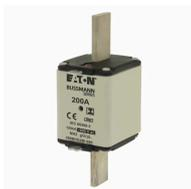
**Cartouche fusible, Basse tension, 200 A, AC 690 V, 120 kA, NH2, gG/gL, IEC, à double indicateur de fusion, pattes d'extraction isolées**
