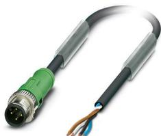
Câble pour capteurs/actionneurs, 4-pôles, PUR exempt d'halogène, gris-noir RAL 7021, connecteur mâle droit M12 SPEEDCONNECT, détrompage: B, sur extrémité libre, longueur de câble: 5 m
