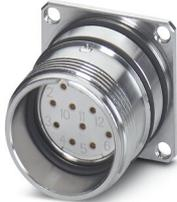
M23, Connecteur d'appareil face arrière, série: RC, droit, blindé: oui, Verrouillage à vis, Nombre de pôles: 8+1, Sens de rotation: standard, type de contact: Connecteur femelle, Cône de soudage, Joint torique radial, 4xM2,5, Epaisseur de paroi min.: 2,7 mm, Epaisseur de paroi max. : 3,5 mm, détrompage: N, Produit de remplacement selon RoHS II sans exception 6c (Pb < 0,1 %) référence : 1240654
