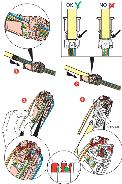
L'épanouissement de câbles et la mise en butée de la gaine dans l'épanouisseur permettent de garantir un respect de 13 mm de dépairage de chaque paire tel que demandé par la norme. L'épanouissement des paires à 90° par rapport au câble assure les meilleures performances.
