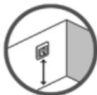
Placez le thermostat à une hauteur adaptée sur le mur (généralement 80-170 cm). Le commutateur peut être placé sur une zone libre du mur.
