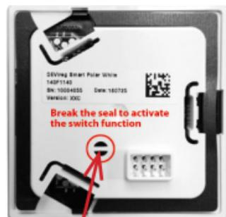
Une option « sonde d'ambiance uniquement » est également disponible. Elle nécessite toutefois de casser le petit sceau plastique et le sceau du circuit imprimé qui se trouve en dessous, à l'arrière du module d'affichage, par exemple à l'aide d'un tournevis. Dans ce cas, une réinitialisation est néces-
