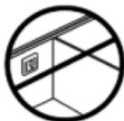
Ne placez pas le thermostat sur la surface interne d'un mur donnant sur l'extérieur, mal isolé.
