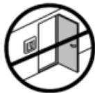
En raison des courants d'air, installez toujours le thermostat à au moins 50 cm des fenêtres et des portes lorsque vous utilisez la régulation en mode sol et pièce ou en mode pièce uniquement.
