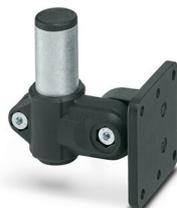
Console murale 75 mm, orientable, avec 4 trous de fixation 6,5 mm et diamètre du logement de 30 mm pour support du boîtier, polycarbonate PC renforcé en fibres de verre, noir et aluminium, 306 g
