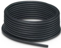
Au mètre, Câble de données, VARAN CAT5 (100 Mbit/s), blindé, SANTOPRENE exempt d'halogène/TPE exempt d'halogène, noir RAL 9005, 6 fils (1x2xAWG22/19 + 1x4xAWG24/19), coloris du fil: marron, bleu, blanc/orange, blanc/vert, vert, orange, longueur de câble: 100 m
