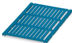
Repère pour conducteur, Plaque, bleu, vierge, repérable avec : TOPMARK NEO, LASER TOPMARK, BLUEMARK ID COLOR, BLUEMARK ID, BLUEMARK CLED, THERMOMARK PRIME, THERMOMARK CARD 2.0, THERMOMARK CARD, type de montage: insertion, plage de diamètre de câble: 1,5 ... 14 mm, surface utile: 30 x 4 mm, Nombre d'étiquettes: 30
