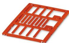
Repère pour conducteur, Planche, rouge, vierge, repérable avec : BLUEMARK ID COLOR, BLUEMARK ID, BLUEMARK CLED, PLOTMARK, CMS-P1-PLOTTER, type de montage: insertion, plage de diamètre de câble: 1,5 ... 14 mm, surface utile: 30 x 4 mm, Nombre d'étiquettes: 16
