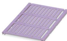
Repère pour conducteur, Planche, violet, vierge, repérable avec : TOPMARK NEO, LASER TOPMARK, BLUEMARK ID COLOR, BLUEMARK ID, BLUEMARK CLED, THERMOMARK PRIME, THERMOMARK CARD 2.0, THERMOMARK CARD, type de montage: insertion, plage de diamètre de câble: 1,5 ... 14 mm, surface utile: 30 x 4 mm, Nombre d'étiquettes: 30
