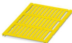
Repère pour conducteur, Planche, jaune, vierge, repérable avec : TOPMARK NEO, LASER TOPMARK, BLUEMARK ID COLOR, BLUEMARK ID, BLUEMARK CLED, THERMOMARK PRIME, THERMOMARK CARD 2.0, THERMOMARK CARD, type de montage: insertion, plage de diamètre de câble: 1,5 ... 14 mm, surface utile: 30 x 4 mm, Nombre d'étiquettes: 30
