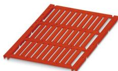
Repère pour conducteur, Planche, rouge, vierge, repérable avec : TOPMARK NEO, LASER TOPMARK, BLUEMARK ID COLOR, BLUEMARK ID, BLUEMARK CLED, THERMOMARK PRIME, THERMOMARK CARD 2.0, THERMOMARK CARD, type de montage: insertion, plage de diamètre de câble: 1,5 ... 14 mm, surface utile: 30 x 4 mm, Nombre d'étiquettes: 30
