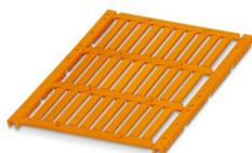
Repère pour conducteur, Planche, orange, vierge, repérable avec : TOPMARK NEO, LASER TOPMARK, BLUEMARK ID COLOR, BLUEMARK ID, BLUEMARK CLED, THERMOMARK PRIME, THERMOMARK CARD 2.0, THERMOMARK CARD, type de montage: insertion, plage de diamètre de câble: 1,5 ... 14 mm, surface utile: 30 x 4 mm, Nombre d'étiquettes: 30
