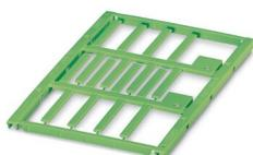
Repère pour conducteur, Planche, vert, vierge, repérable avec : BLUEMARK ID COLOR, BLUEMARK ID, BLUEMARK CLED, PLOTMARK, CMS-P1-PLOTTER, type de montage: insertion, plage de diamètre de câble: 1,5 ... 14 mm, surface utile: 30 x 4 mm, Nombre d'étiquettes: 16
