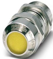
Presse-étoupe, matériau du raccordement vissé: Laiton, nickelé, application: Ex, diamètre extérieur du câble 6 mm ... 13 mm, blindage: oui, filetage de raccordement: M20 x 1,5, coloris: argenté, avec joint torique
