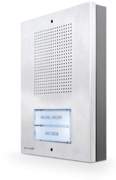
Platine extérieure audio série Extra avec 2 boutons d'appel. Enjoliveur en acier inox et rétroéclairage de l'étiquette porte-noms de couleur blanche. Elle est équipée d'un boîtier à encastrer et d'un support pour montage en saillie. Dimensions 95 x 135 x 6,5 mm (encastré - 25 mm (en saillie). Câblage 5 fils.
