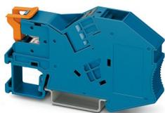
Bloc de jonction d'installation, avec fonction de butée, tension nominale: 1000 V, intensité nominale: 70 A, Raccordement Push-in, 1er étage, Section de référence: 16 mm<sup>2</sup>, section : 0,5 mm<sup>2</sup> - 25 mm<sup>2</sup>, type de montage: NS 35/7,5, NS 35/15, coloris: bleu
