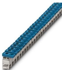
Bloc de jonction, tension nominale: 300 V, intensité nominale: 125 A, type de raccordement: Raccordement vissé, Section de référence: 35 mm<sup>2</sup>, section : 2,5 mm<sup>2</sup> - 35 mm<sup>2</sup>, montage: Barre collectrice de N, coloris: bleu
