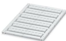
Repères pour blocs de jonction, à commander : sous forme de plaque, blanc, impression selon les indications du client, type de montage: encliquetage dans la rainure de repérage plate, pour bloc de jonction au pas de : 6,2 mm, surface utile: 5,4 x 4,7 mm, Nombre d'étiquettes: 60
