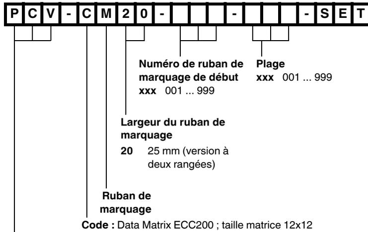
Position Coding System, Vision Technology (système de codage de position, technologie Vision)
