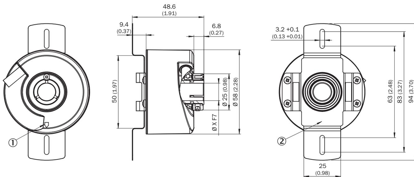
Valeurs XF7, voir le tableau des diamètres d'axe pour le type axe creux traversant, serrage arrière
