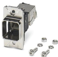
Cadre de montage RJ45, IP67, pour verrouillage Push-Pull, métallique, pour découpe de montage rectangulaire, avec joint, vis de fixation et embout RJ45 avec raccordement de câble IDC
