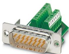
Elément de contact D-SUB , taille Shell 2, avec 15 contacts de signalisation, type de contact mâle, raccordement à vis, droit, pour cadre de montage et capot passe-câble en indice de protection IP67
