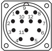
Vue connecteur d'appareil M23 sur le codeur
