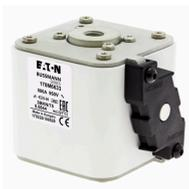
**Cartouche fusible, grande vitesse, 700 A, AC 2000 V, size 3, 74 x 90 x 155 mm, aR, IEC, indicateur de fusion simple**
