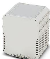
Boîtier électronique sur rail DIN, Boîtier complet avec pied métallique de verrouillage, design élancé, avec fentes d'aération, largeur: 90,4 mm, hauteur: 99 mm, profondeur: 113,65 mm, coloris: gris clair (7035), connexion transversale: Connecteur de bus sur rail DIN (en option), nombre de pôles connecteur transversal: 5
