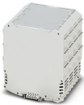
Boîtier électronique sur rail DIN, Boîtier complet avec pied métallique de verrouillage, design élancé, avec fentes d'aération, largeur: 90,4 mm, hauteur: 99 mm, profondeur: 113,65 mm, coloris: gris clair (7035), connexion transversale: Connecteur de bus sur rail DIN (en option), nombre de pôles connecteur transversal: 5
