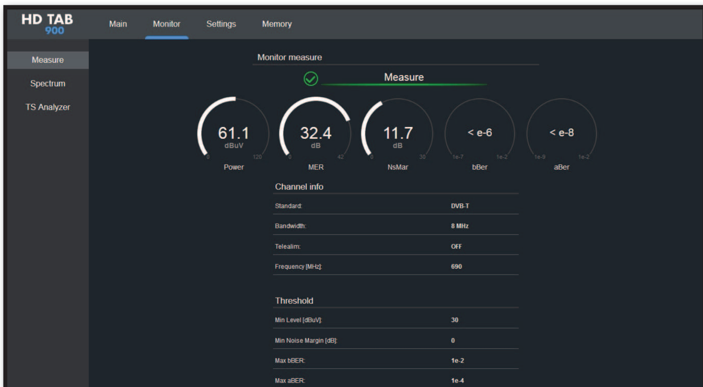
Exemple de MESURES d'une CANAL TV (Norme DVB-T) et écran associé de RÉPONSE IMPULSIONNELLE (ÉCHOS)
