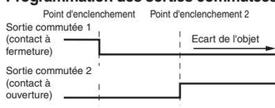
Point d'enclenchement 1 -> ∞: Sortie commutée 1, (contact à fermeture)
