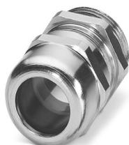
Presse-étoupe, matériau du raccordement vissé: Laiton, nickelé, diamètre extérieur du câble 11 mm ... 17 mm, blindage: non, filetage de raccordement: M25 x 1,5, coloris: argenté, avec joint torique
