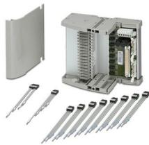
Termination Carrier universel pour raccorder 16 amplificateurs-séparateurs MINI Analog à des cartes d'entrée/sortie TOR ou analogiques, via des connecteurs D-SUB, 37 pôles (liaison 1:1), avec raccordement de multiplexeur HART
