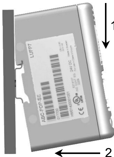
Montage de la passerelle
