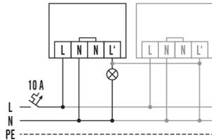
Raccordement en parallèle de 8 appareils au maximum.
