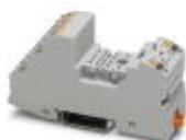
Embase de relais RIF-2..., pour relais industriels avec 2 ou 4 contacts inverseurs, raccordement Push-in, enfichabilité pour modules d'entrée/antiparasite, montage sur NS 35/7,5
