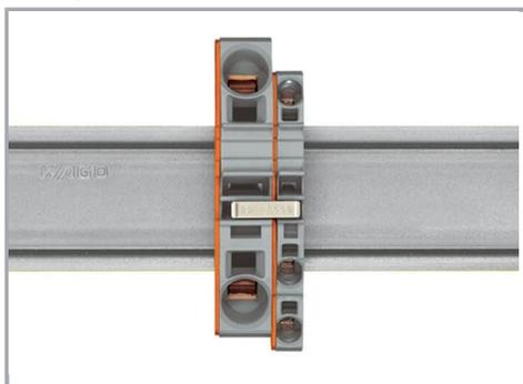
Lors du pontage avec des contacts de pontage réducteur il faut toujours prévoir une plaque d'extrémité entre les bornes à ponter.
