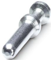
Contact à sertir, diamètre de contact: 4 mm, tournés, Mâle, matériau de contact: Alliage de cuivre, sans plomb, surface des contacts: plaqué argent, section raccordable: 1,5 mm<sup>2</sup> ... 1,5 mm<sup>2</sup>, AWG 16
