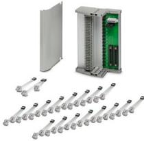
Termination Carrier pour la connexion redondante de 16 amplificateurs-séparateurs MACX Analog Ex i aux cartes d'entrée analogiques de la commande Yokogawa CENTUM VP, via deux connecteurs KS40 à 40 pôles. Adapté pour les cartes Yokogawa AAI141 et AAI143.
