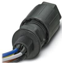
Traversée de paroi, Raccordement QUICKON, nombre de pôles: 4+PE, Mâle, 690 V, 20 A, noir, avec écrou QUICKON, diamètre extérieur du câble: 6 mm ... 11 mm, filetage de montage: M25, Fils individuels (soudé), 2,5 mm<sup>2</sup>, fils coupés nets, longueur du câble: 0,5 m
