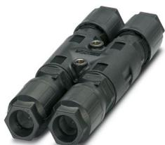
Répartiteur en H QUICKON, noir, 4 pôles + PE, 1,0 mm<sup>2</sup> ... 2,5 mm<sup>2</sup> / 690 V / 20 A, pour diamètre de câble 6 mm ... 11 mm, avec un boulon de fermeture.
