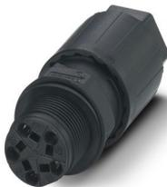
Traversée de paroi, Raccordement QUICKON, nombre de pôles: 4+PE, Mâle, 690 V, 20 A, noir, avec écrou QUICKON, diamètre extérieur du câble: 6 mm ... 11 mm, filetage de montage: M25, Raccordement Push-in
