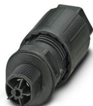
Traversée de paroi, Raccordement QUICKON, nombre de pôles: 4+PE, Mâle, 690 V, 15 A, noir, avec écrou QUICKON, diamètre extérieur du câble: 6 mm ... 11 mm, filetage de montage: M20, Raccordement par clips (pour clips selon DIN 46247-2)
