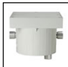
S.3660 BOÎTE DE JONCTION IP65* Puisarde de dérivation pour câblage fourni avec presse-étoupe pour 3 entrées (3 entrées supplémentaires que l'on peut ouvrir avec l'accessoire S.3670) Charge maximum 500 Kg. Dimensions 300mmx300mmx230mm
