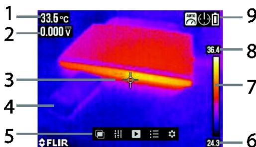
1. **Mesure de température IR** : représente la température du point ciblé. Notez que lors de l'initialisation de l'imageur, des tirets s'afficheront.
