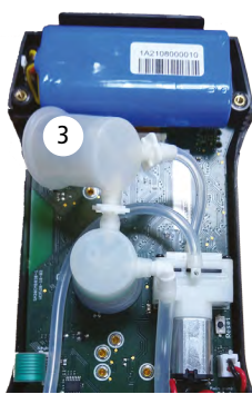
Cellule retirée de sa protection blanche
