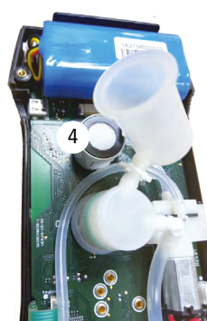
Nouvelle cellule connectée à la carte électro-
