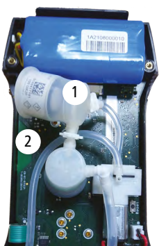
Protection blanche avec sa cellule retirée
